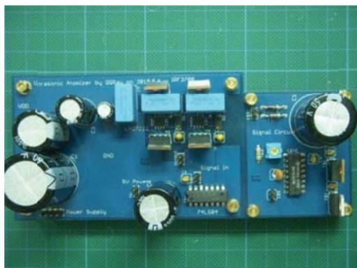
Figure 5 霧化器電路
