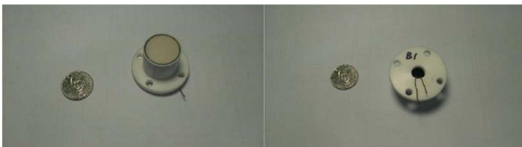
Figure 1 壓電超音波換能器
